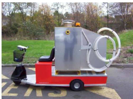
Le **MOBISABLE NEU type LMU** est une unité mobile légère de remplissage de sable, entièrement autonome durant l'opération de remplissage. Sa grande maniabilité lui permet d'atteindre les zones difficiles d'accès. Il est particulièrement adapté aux sablières de petite capacité (débit de sable 10 à 15 l/min) et aux réseaux exploitant un nombre restreint de rames.
